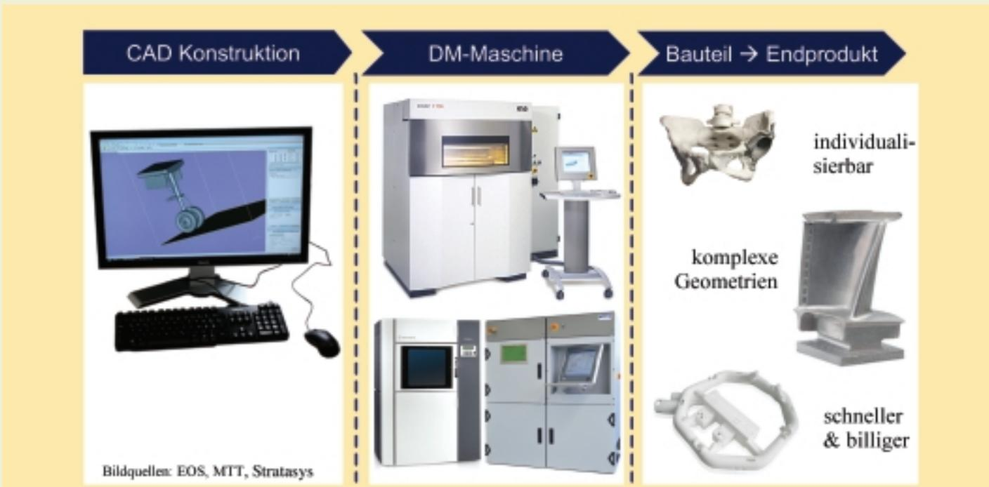
Abb. 1: Grundprinzip der direkten Fertigung von der CAD-Zeichnung unmittelbar zum fertigen Endprodukt.
