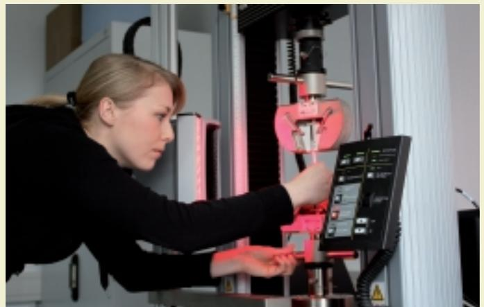
Abb. 7: Ermittlung der Zugfestigkeit von gesinterten Probenkörpern.
