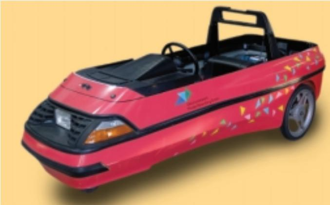
Abb. 10: Elektrofahrzeug mit hybridem Energiespeichersystem (Studentenprojekt).
