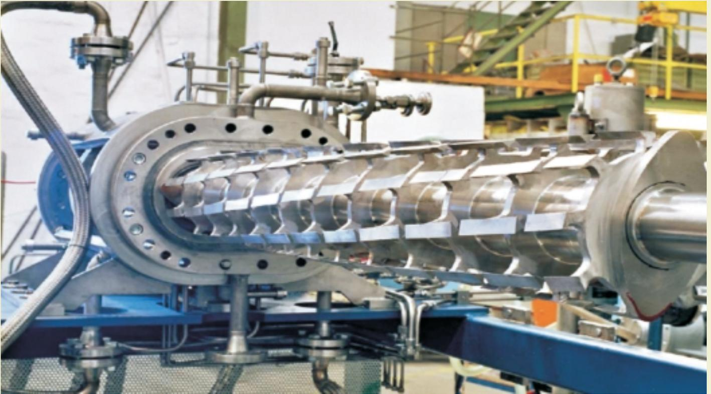
Abb. 1: Mischwerkzeug eines Kneters.
