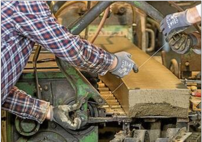
Am sogenannten Abschnieder entstehen im Sekundentakt Ziegelrohlinge. Foto: LWL/Harms
