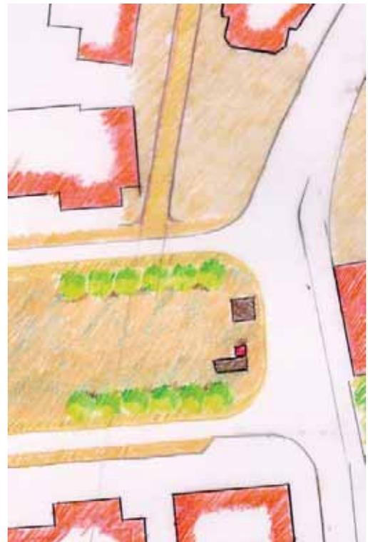
78 Entwurfsalternative mit verlegtem Aufzug und Treppenabgang in einen vorhandenen Lüftungsschacht
