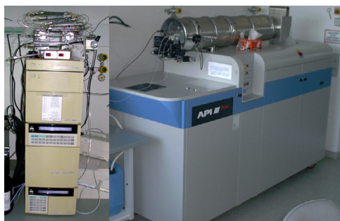
Abb. 52: Eines der ersten in der Rückstandsanalytik genutzten Massenspektrometer (links) im Vergleich zu einem aktuell im Einsatz befindlichen Gerät (rechts)
