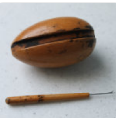
Imra Laufmaschinen-Stopfei, 1950er Jahre (und Fangnadel oder Repassiernadel)
