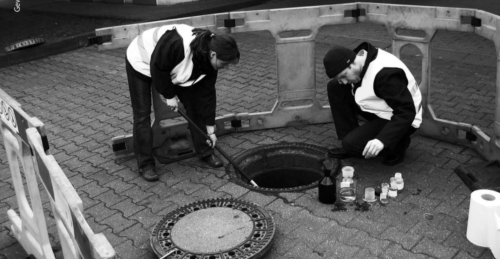
Um die Wirksamkeit der Abtrennung von Kraftstoffen aus dem Wasser vor dem Übergang in die Kanalisation zu untersuchen, nehmen die Wissenschaftler Proben im Gully an einer Tankstelle.
