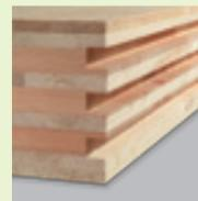
**Brettsperrholz** Brettsperrholz (BSP) besteht aus einer ungeraden Anzahl kreuzweise miteinander verklebter Brettlagen, wobei der Querschnitt symmetrisch aufgebaut sein muss. Es wird vor allem für tragende und aussteifende Wand-, Decken- und Dachbauteile bei Ein- und Mehrfamilienhäusern und Industrie- und Verwaltungsbauten verwendet.
