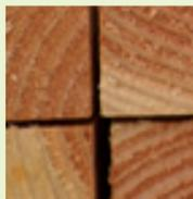
**Bauschnittholz und Hobelware** Bauschnittholz wird durch Einschneiden oder Profilieren aus Rundholz gewonnen. Dabei werden hauptsächlich die einheimischen Nadel- oder Laubhölzer verwendet. Anwendungsgebiete sind Holzkonstruktionen und andere Bauweisen. Die Holzfeuchte von Bauschnittholz für tragende Zwecke muss < 20 % betragen.
