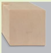
**Konstruktionsvollholz** Konstruktionsvollholz (KVVH<sup>®</sup>) ist ein visuell oder maschinell sortiertes, technisch getrocknetes Vollholz aus qualitätskontrollierter Herstellung mit definierter Maßhaltigkeit für tragende und aussteifende Konstruktionen oder Wand-, Decken- und Dachkonstruktionen im Holzhausbau. Es besteht eine Gütesicherung und Kennzeichnung für KVVH<sup>®</sup> mit oder ohne Keilzinkung.
