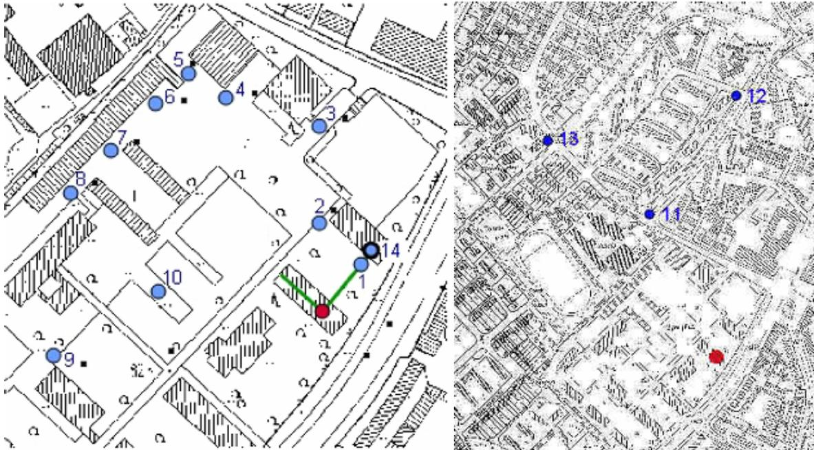
**Abb. 4** : Lage der Messpunkte (blau) im Umfeld der TETRA-Sendeanlage (rot)
