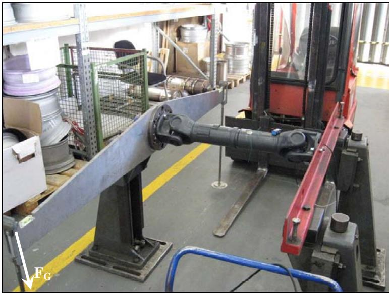
**Abbildung 15:** Kalibriereinrichtung für Kardanwellen
