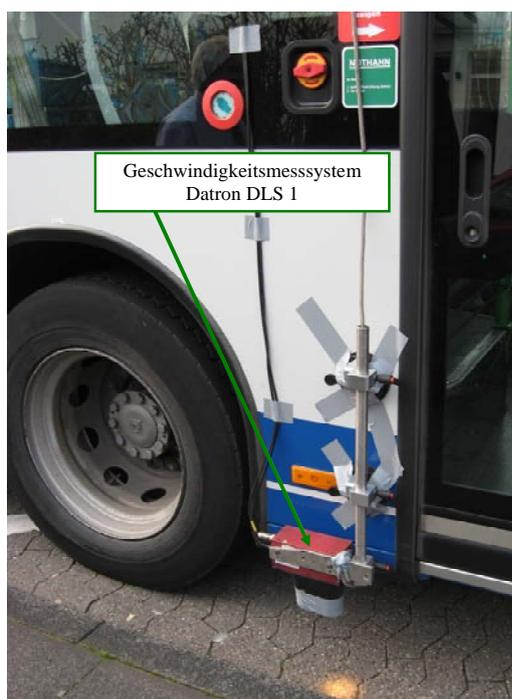
**Abbildung 16:** Geschwindigkeitsmesssystem am Fahrzeug
