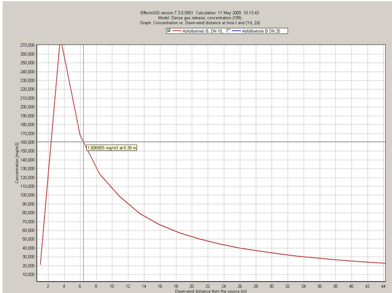
**Diagramm A4.5-5:** CO<sub>2</sub>-Konzentrationsprofil in Atemhöhe 1,5 m bei Stutzenabriss DN10 (Markierung = 9 Vol.-% CO<sub>2</sub>)
