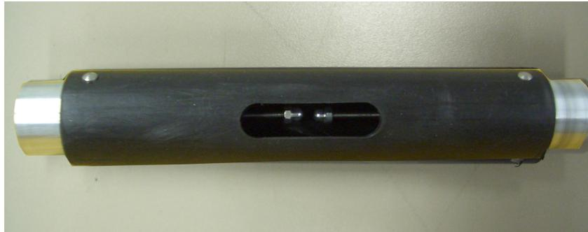
Abb.11: Funkenstrecke mit Kugelelektroden
