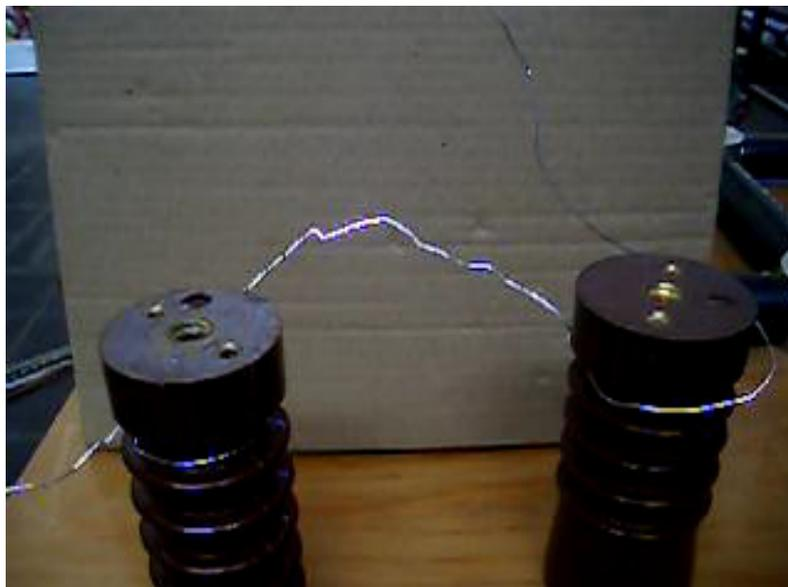
Abb.17: Spitze- Spitz Anordnung bei Funkenschlag (25mm)
