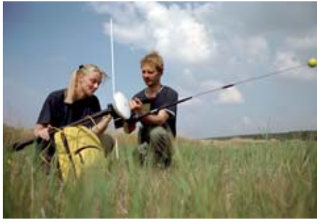
Biodiversitätsforschung: GPS-Messen auf den Elbwiesen bei Steckby dient der Festlegung und dem Wiederfinden von Untersuchungsflächen.
