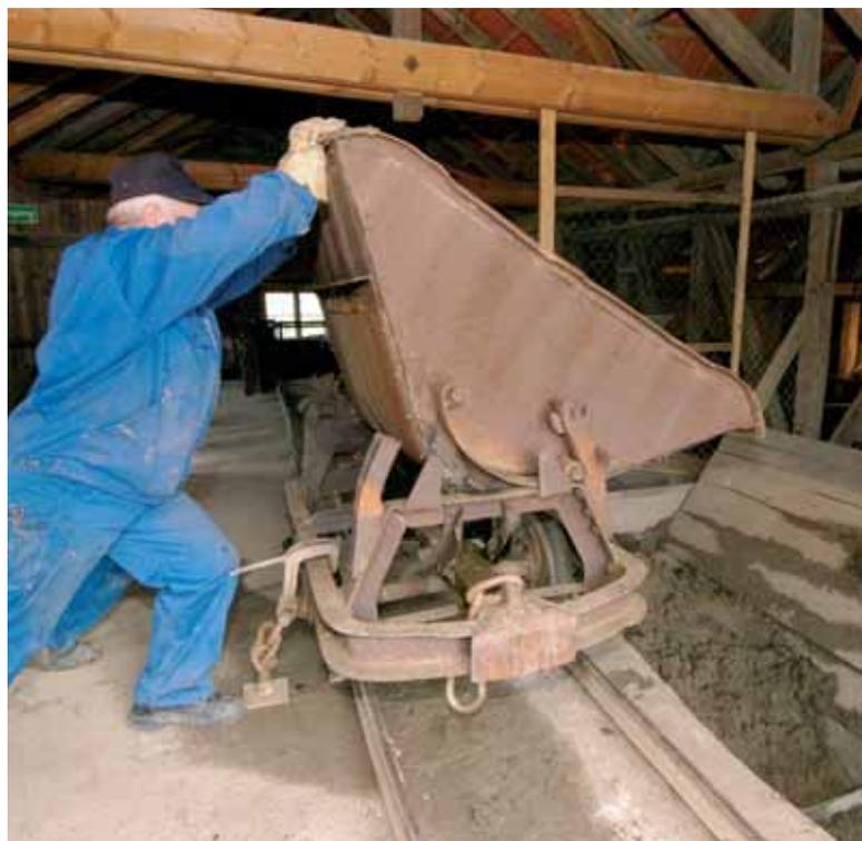
*Die mit Lehm gefüllte Lore wird in die Maschinenziegelei entleert.*
