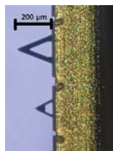
Abb. 2: Foto für die Kraftspektroskopie genutzter Kraftsensoren.
