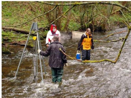
Abbildung 4: Einfrieren von Sedimentproben zur Entnahme als Gefrierkerne; phot. R. Mena
