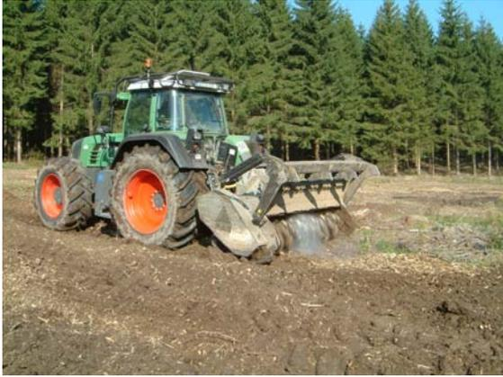
Abbildung 4: Forstmulcher beim Zerkleinern von Baumstubben.
