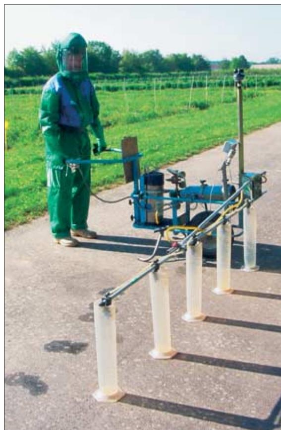
Für den Rückstandsversuch muss die handgeführte Parzelspritze exakt ausgelitert und eingestellt werden.
