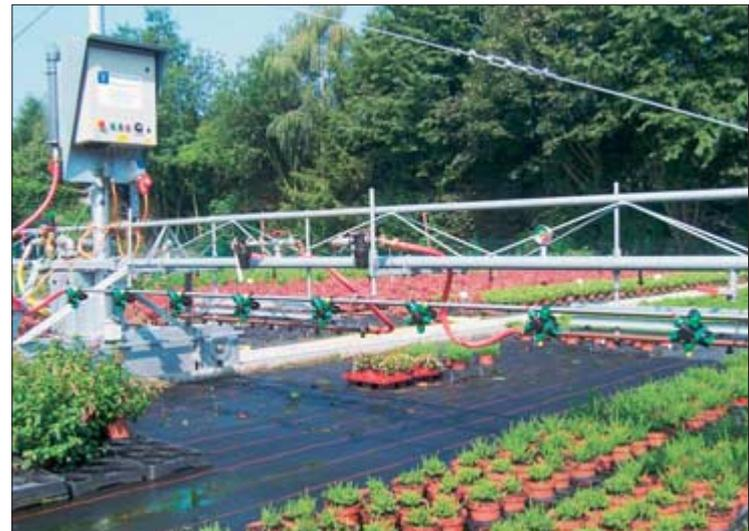
Versuchsgießwagen im Gartenbauzentrum Straelen mit Mehrfachdüsenkörpern.
