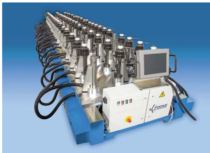
Die Spannvorrichtung ist flexibel erweiterbar auf bis zu 256 Einheiten.
