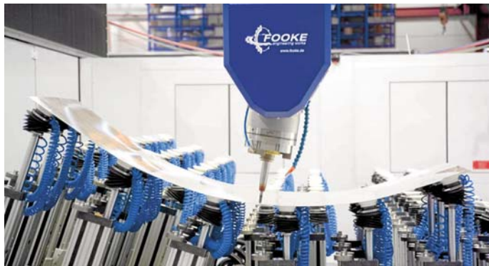
Optimierte Bearbeitung von zwei- und dreidimensional gekrümmten Alublechen und Kohlefaserschalen. Foto: Fooke Maschinenbau
