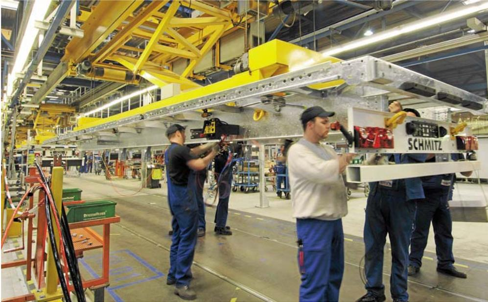
Fließfertigung bei Schmitz Cargobull im Werk Altenberge: Mussten die Mitarbeiter früher zum Bauteil gehen, kommt es nun zu ihnen. In der Linie wird das Montagematerial in einem festen Takt geliefert.
