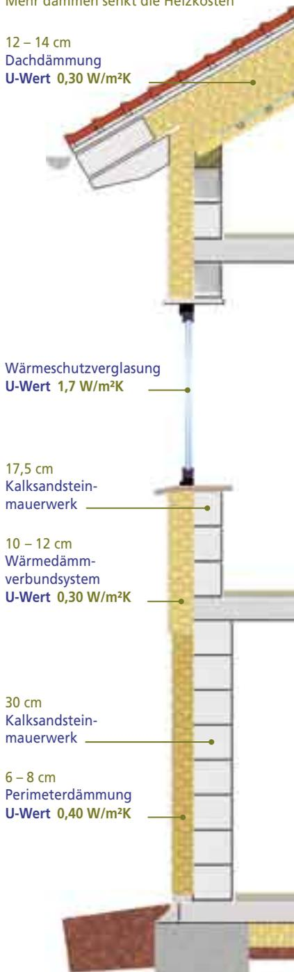
Das Wärmedämmverbundsystem (WDVS) wird bei bestehenden Fassaden direkt auf den vorhandenen Außenputz aufgebracht.
