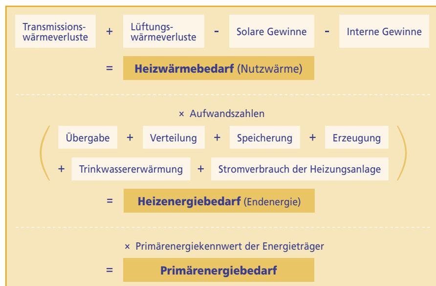
Die EnEV begrenzt den jährlichen Primärenergiebedarf eines Gebäudes. Bei der Berechnung wird zunächst der Heizwärmebedarf für Transmissions- und Lüftungsverluste abzüglich der solaren und internen Gewinne ermittelt.
