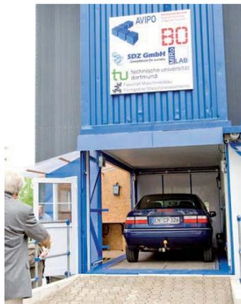
Beispielhaft für andere Güter: Ein Auto wird automatisch im Containerlagersystem deponiert.
