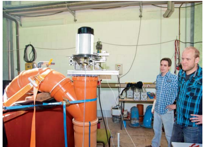
André Dunker (rechts) und Sven Bosse nutzen die Möglichkeiten und die intensive Unterstützung des Wasserbaulabors, um die Leistungsfähigkeit der Heberturbine zu testen.
