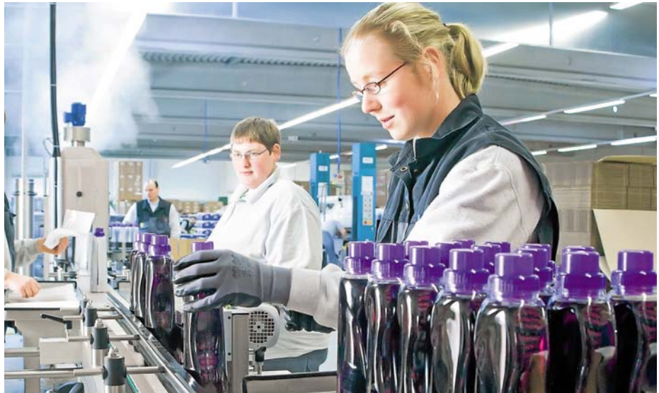
Diana Bömer (links) und Andrea Hille versehen Flaschen mit Sleeves. Diese Etiketten ermöglichen ein flexibles Verpackungsdesign..
