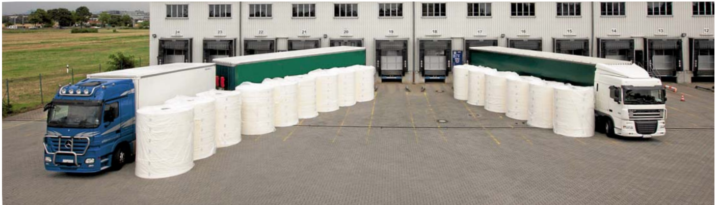
Im Vergleich: Lademenge eines herkömmlichen und eines Lang-Lkw mit Papierrollen.
