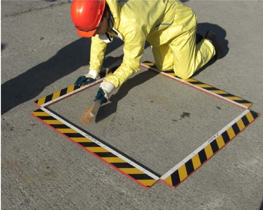
**Abbildung 2** Durchführung einer Fegeprobe
