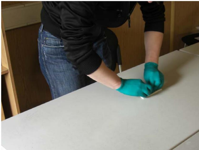
**Abbildung 3** Entnahme einer Wischprobe
