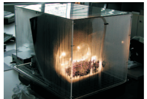
Betauungstestkammer eines Scheinwerfers
