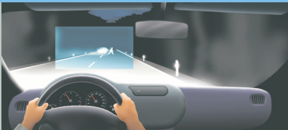
Head-Up-Display eines Nachtsichtsystems (Quelle: Hella KG Hueck & Co.)
