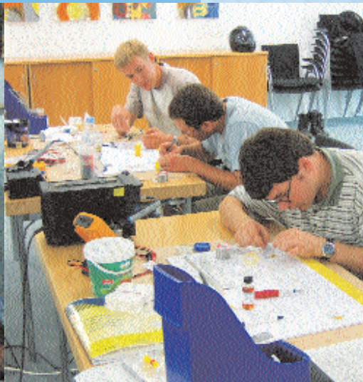
Teilnehmer an ihren Arbeitsplätzen während einer praktischen Übung – Vorbereitung von Dehnmessstreifen und Proben
