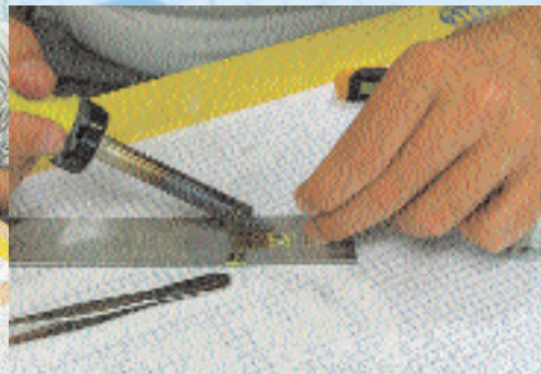
„Ruhige Hände gefragt“ – Präzisionsarbeit beim Anlöten der DMS-Anschlussbändchen an Lötstützpunkten
