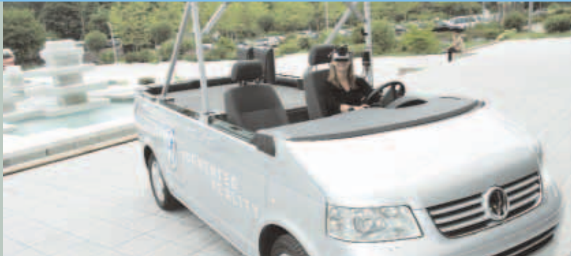
Die Mobile Augmented-Reality-Versuchsplattform: Reales Fahrzeug und virtueller Innenraum verschmelzen zu einem neuen Prototypen (Foto: Jan Braun/HNF)
