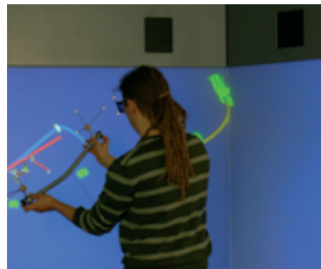
Innovatives Eingabegerät für die interaktive Verlegung von Schläuchen und Kabeln in einer virtuellen Umgebung (FH Düsseldorf/flexIlution GmbH)
