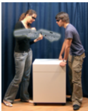
AR-Präsentationssystem: Einblendung von virtuellen Objekten in das Sichtfeld der Benutzer (Heinz Nixdorf Institut/Hettich International)
