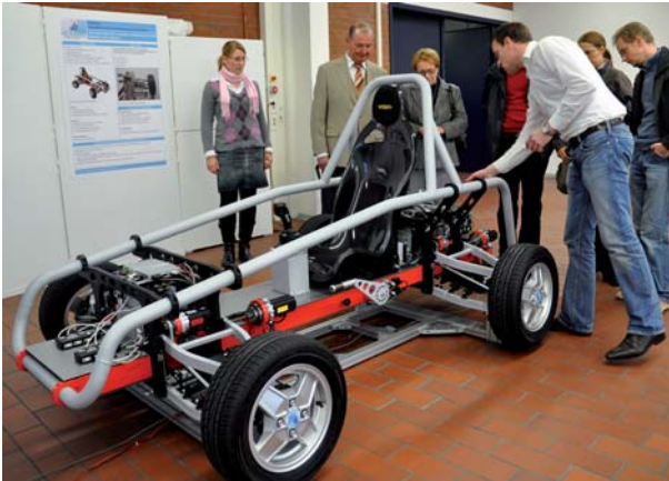
Dipl.-Ing. Egor Sawazki präsentiert das elektrische X-by-Wire Versuchsfahrzeug „Chamäleon“ im Labor des Lehrstuhls für Regelungstechnik und Mechatronik.
