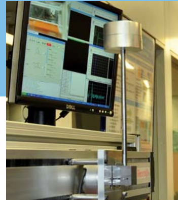
Das „Inverse Pendel“ ist ein Demonstrator. Ein Regler schwingt das Pendel auf, bis es in der Ruhelage ist. Der Regler balanciert es in dieser Position konstant.
