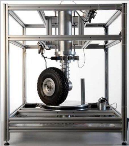
Gemeinsam mit dem Lehrstuhl für Regelungstechnik und Mechatronik erstellter Steer-By-Wire TIMMO-Projektdemonstrator
