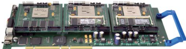
Demonstrator des weltraumgeeigneten Informationsverarbeitungsmoduls (DRPM) auf der Basis des in der Fachgruppe Schaltungstechnik entwickelten Rapid-Prototyping-Systems RAPTOR-X64
