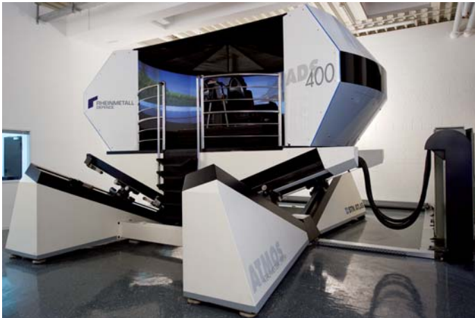
Der Fahrsimulator der Universität Paderborn bildet den Kern einer innovativen Test- und Trainingsumgebung für fortgeschrittene Fahrerassistenzsysteme.
