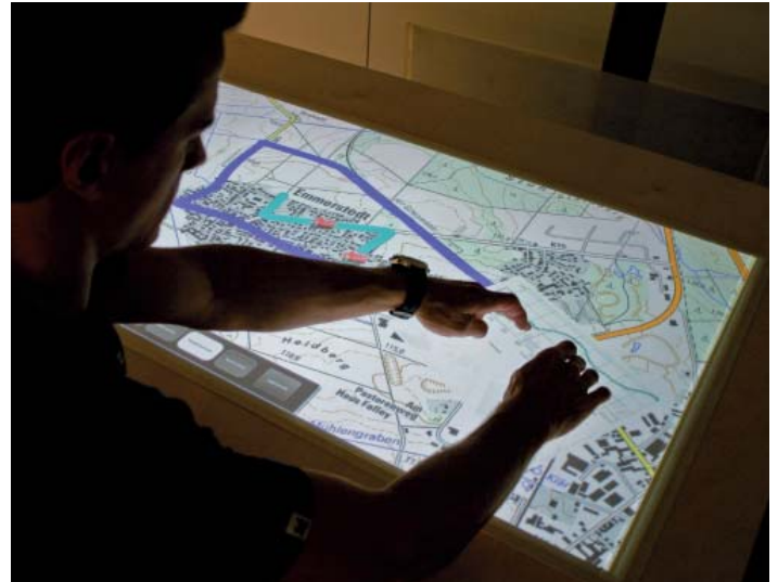
Der useTable ermöglicht Standard-Interaktionen, wie das Positionieren und Skalieren von Objekten, durch mehrere Finger.
