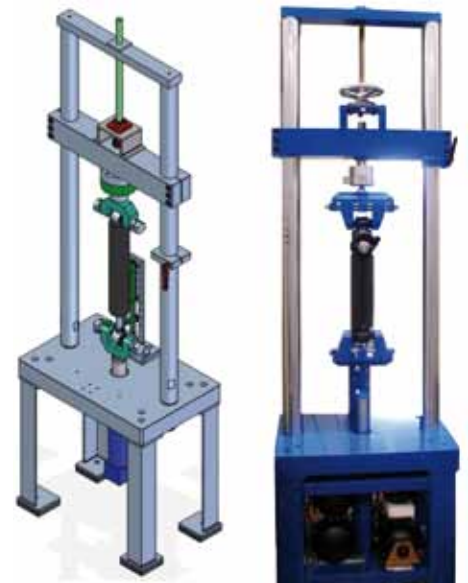
Bild 2: Federbeinprüfstand mit eingespanntem semi-aktivem Dämpfer
