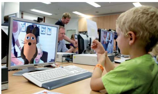
Augmented Reality: Die Kamera erkennt den Marker und zeigt die 3D-Maus.
