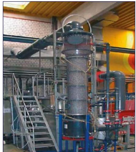
Absorptionsanlage mit Füllkörperkolonne
