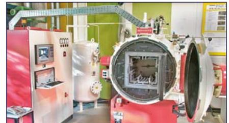
Sintern und Wärmebehandeln
