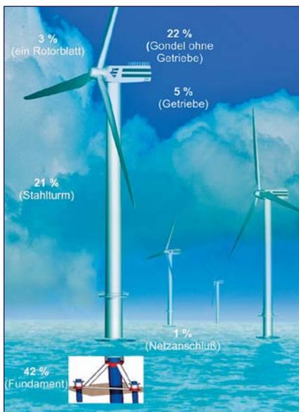
Aufteilung des Kumulierten Energieaufwandes zur Herstellung einer Off-Shore-Windenergieanlage
