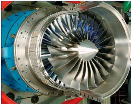
Fan für Ultra-Hoch-Bypass-Triebwerke
