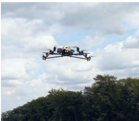
Abb. 4: Fernerkundung mit Hilfe eines Oktocopters, durchgeführt vom MMI, RWTH Aachen University. Fotos: RWTH Aachen
