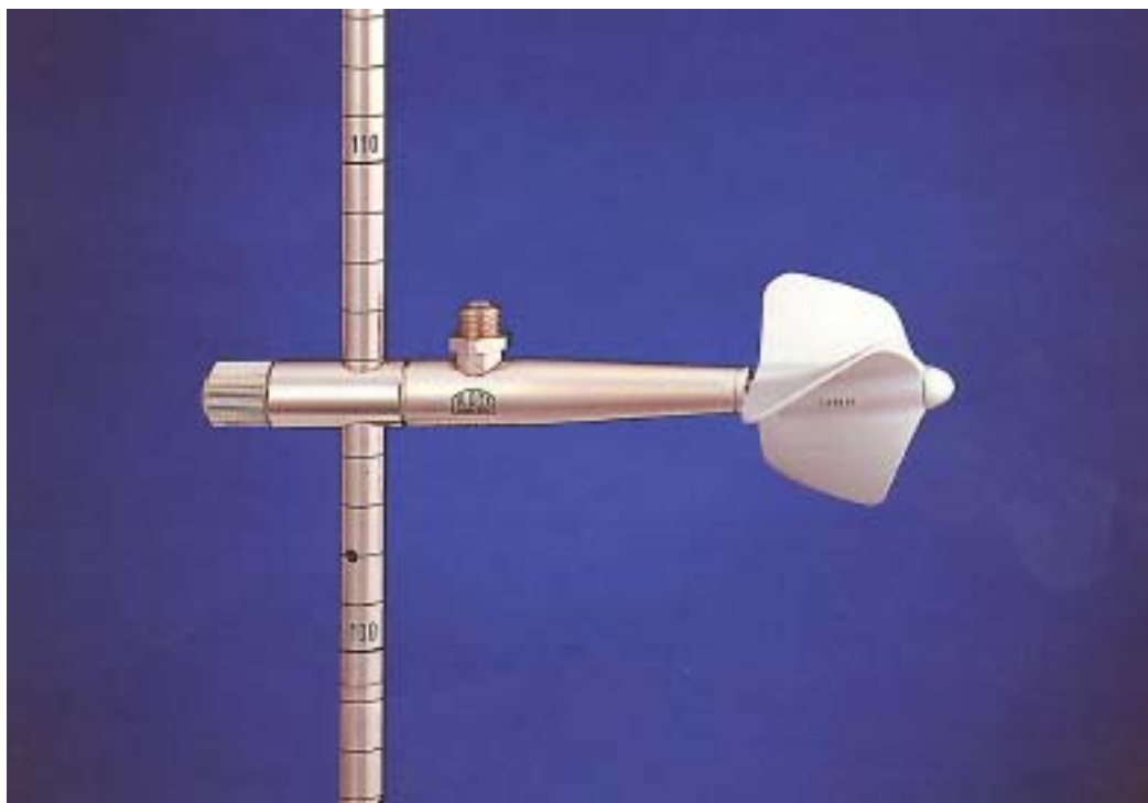
Bild 1: Laborflügel C2 der Firma Ott zur Ermittlung der Strömungsgeschwindigkeit bei geringen Wassertiefen
