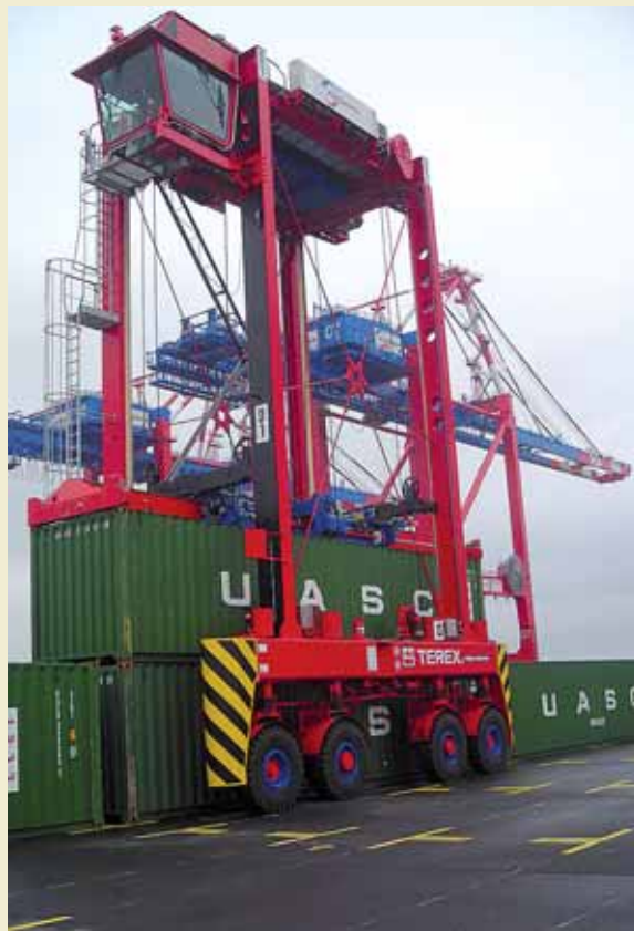
Abb. 5: Umschlaggeräte für ISO-Container: Reach-Stacker (Portalhubwagen).
