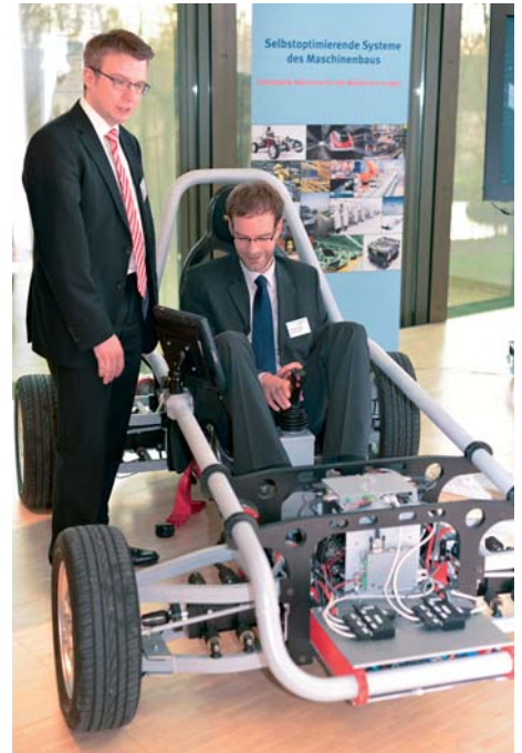
Probefahren im X-by-Wire Versuchsfahrzeug Chamäleon.
