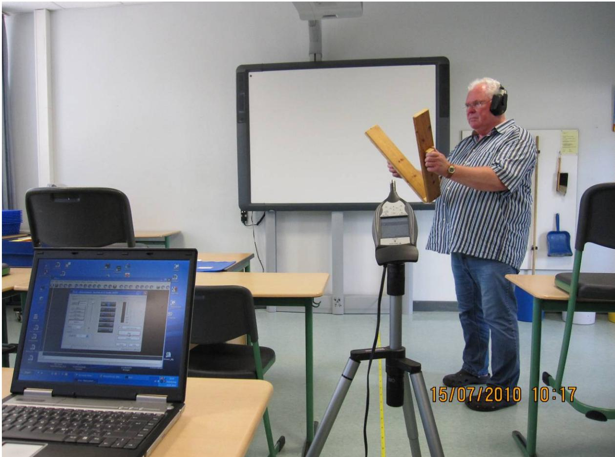
Abb. 11: Rechner in Verbindung mit einem Schallpegelmesser als Mikrofon. Der vom Impulsgeber erzeugte „140 dB-Knall“ wird aufgezeichnet und verrechnet. Die Software liefert eine differenzierte Aufschlüsselung des Nachhalls im Frequenzbereich von 125 Hz bis 8 Khz.
