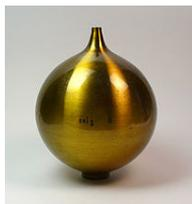
**Helmholtzresonatoren**, werden in der Regel auf tiefe Frequenzen abgestimmt.
