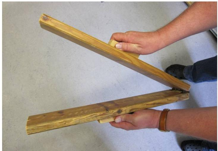
Abb. 8: selbstgebauter Impulsgeber (140 dB) alternativ zur üblicherweise eingesetzten Pistole
