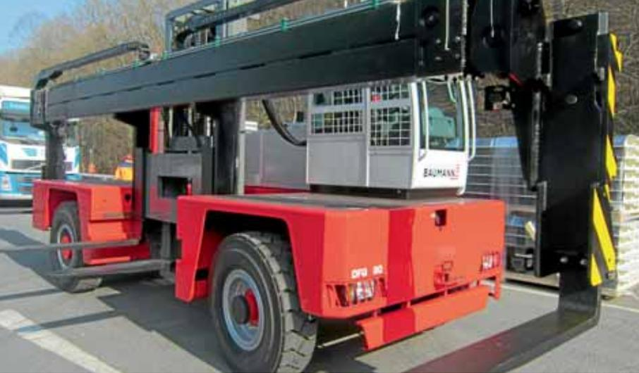
Dieser Seitenstapler mit teleskopierbarer Langguttraverse, höhenverstellbaren Gabelzinken und Kamerasystem ermöglicht den Transport von 25 Meter langen Blechen.
