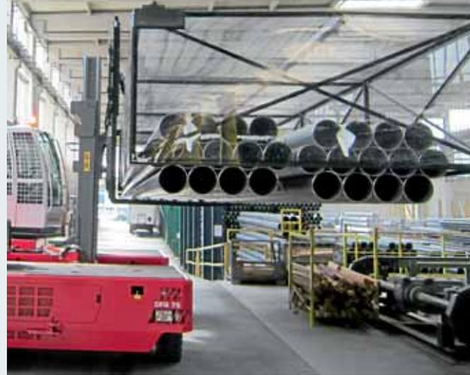
Eine Regenabdeckung schützt die zwölf Meter langen Rohrpakete vor Witterungseinflüssen.
