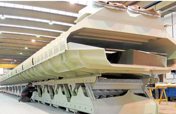
72 000 Kilogramm wiegt der Gusskühler von Jöst in Dülmen. Foto: Jöst
