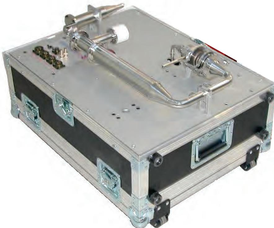
**Abbildung 14:** Gravimetrisches Partikelmessgerät Micro PSS [Quelle: Control Sistem]
