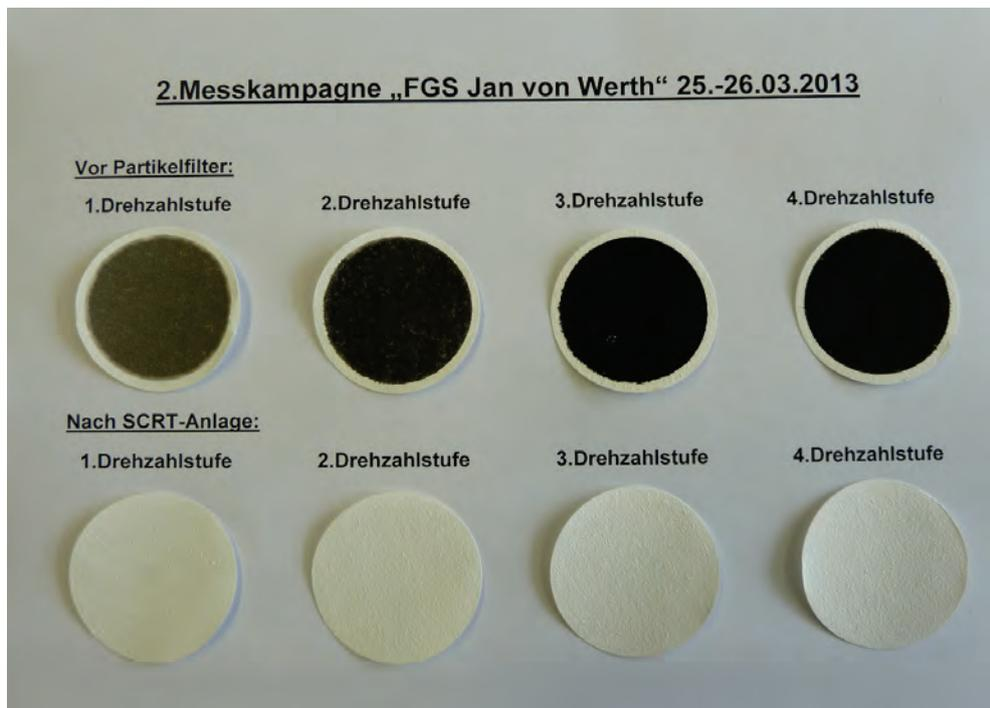
**Abbildung 38:** Partikelfiltervergleich mit / ohne DPF-Filtereinsatz (2. Messkampagne)
