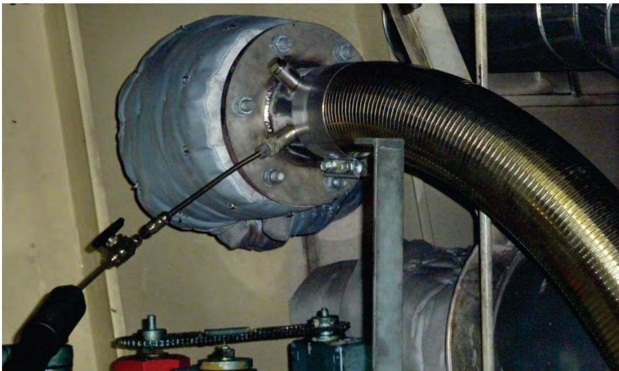
**Abbildung 18:** Umbau der Abgasleitung für die Rohemissionsmessung
