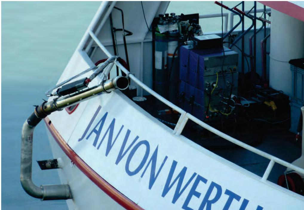
**Abbildung 19:** Abgasmassenbestimmung am Austritt der Abgasleitung
