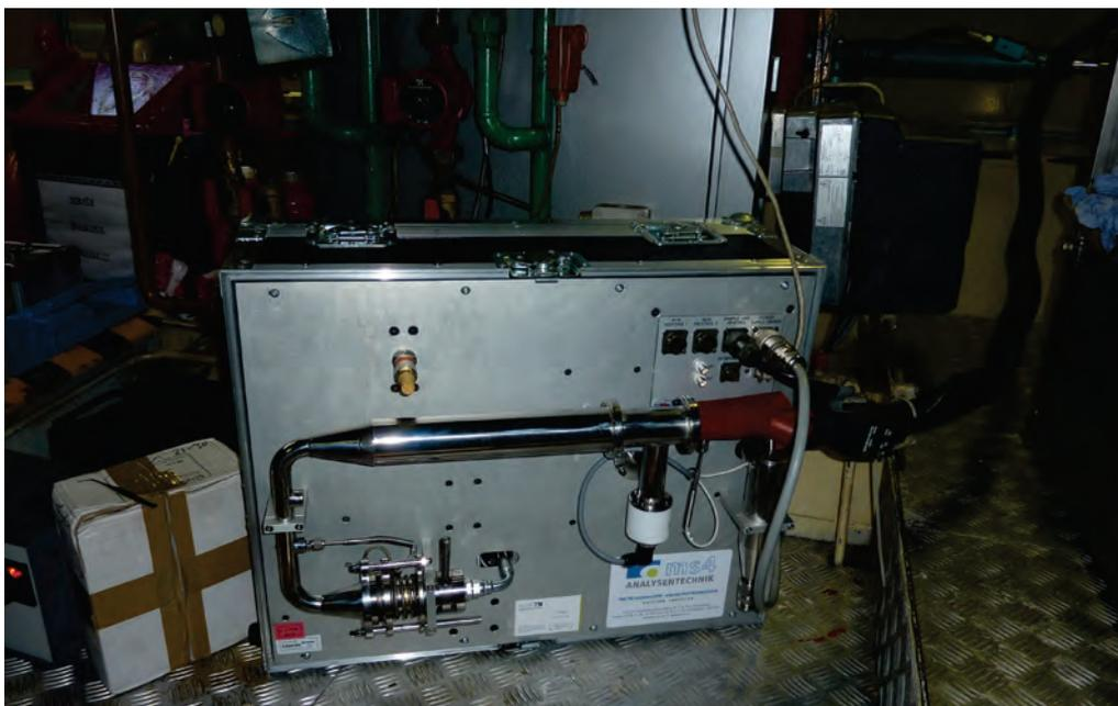
**Abbildung 20:** Gravimetrische Partikelmessung im Motorraum
