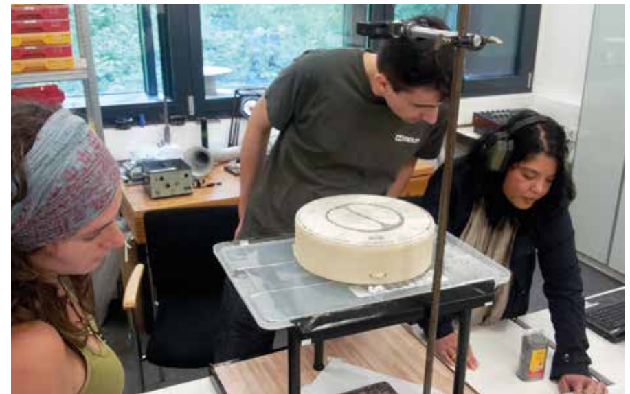
Practical music acoustics: Bestimmung der Eigenschwingformen einer Trommelmembran (Chladni-Figuren).
