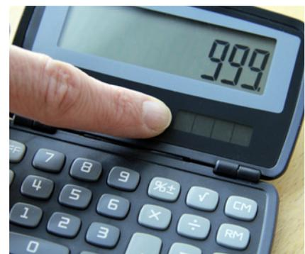
Du kennst eine sehr kleine Photovoltaikanlage aus dem Taschenrechner. Hier sorgen wenige kleine Solarzellen dafür, dass der Taschenrechner auch ohne Batterien funktioniert. (B. Balsliemke)
