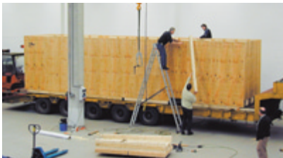
Vorher – nachher: Die riesige Lasergravurmaschine wird für die lange Schiffsreise nach genauen statischen Berechnungen ummantelt und so transportfähig gemacht.
