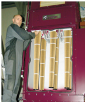
Erfahrung und Praxisnähe bis in die Geschäftsführung: Geschäftsführer Antonius Heitmann setzt selbst die neuartigen Filter in die von AGTOS entwickelte Filteranlage ein.
