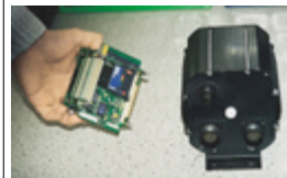
Die Hardware: Links sieht man das Innere des Computers. Rechts die outdoor-taugliche EmbiCube-Hülle.
