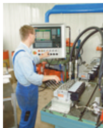
Moderne Technik an einem Hydraulik-Prüfstand bei der Th. Niehues GmbH. Foto: Niehues
