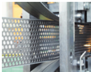
Ganz ohne zu schweißen: Mechanisch werden mit der DAVEX-Technologie Steg und Gurt zu kraft- und formschlüssigen Trägern und Profilen verbunden.
