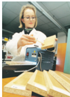
Strahlenhärtable Lacksysteme der BASF Coatings AG tragen zur Reduzierung der Emission organischer Lösemittel bei. Die Beschichtungsmasse härten in extrem kurzer Zeit mit Elektronenstrahlen oder ultraviolettem Licht aus, so dass eine energieaufwendige Trocknung im Ofen entfällt. Auch temperaturempfindliche Substrate wie Papier, Holz und Kunststoffe lassen sich damit veredeln und schützen. Hier führt BASF-Mitarbeiterin Nicole Stegemann an einem UV-Kanal Laborversuche mit den ökoeffizienten Materialien durch. Foto: BASF
