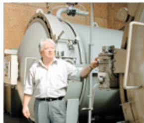
Bio-Reinigung: Mit Druck, der in großen Kesseln erzeugt wird, werden Schädlinge in Rohwaren bekämpft.
